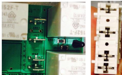
**Le remplacement direct n'est pas possible. La modification du connecteur est nécessaire. Pour permettre la connexion, vous devez retirer le logement en plastique empêchant l'insertion de la broche supplémentaire.**
